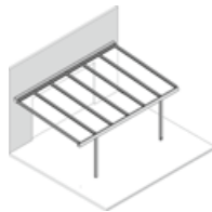
B2 bündig, eingerückt flush, posts recessed
